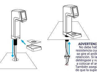
ADVERTENCIA: No debe haber resistencia cuando se gire el anillo de retención. Si la hay, deténgase y vuelva a colocar el anillo. También asegúrese de que la superficie plana del anillo esté orientada hacia el mostrador.
