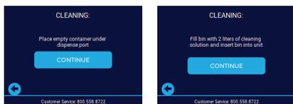
**8** Debajo del punto de dosificación, asegúrese de colocar un recipiente vacío para contener la solución de limpieza después de que ha pasado por el proceso de limpieza.
